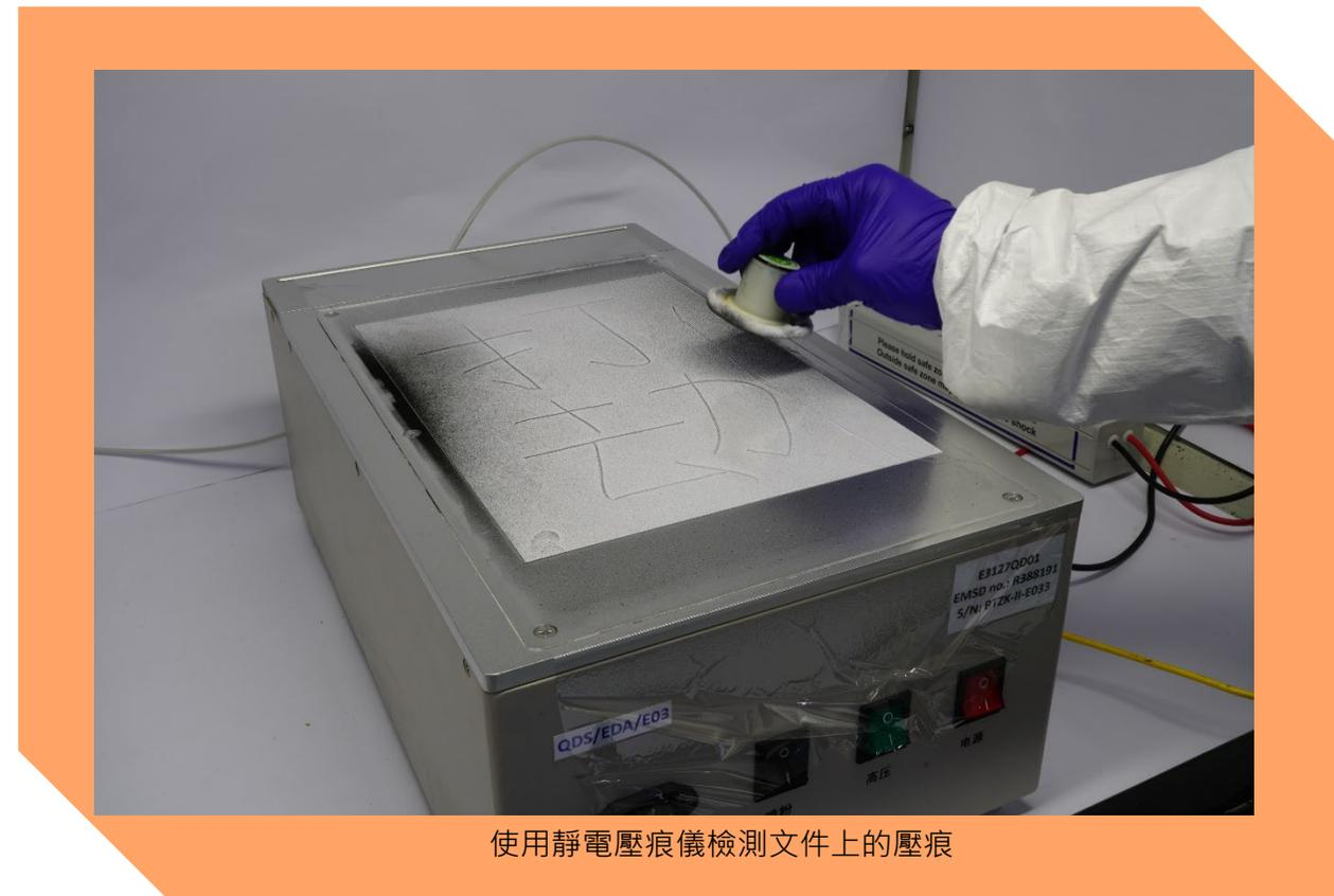
使用靜電壓痕儀檢測文件上的壓痕
