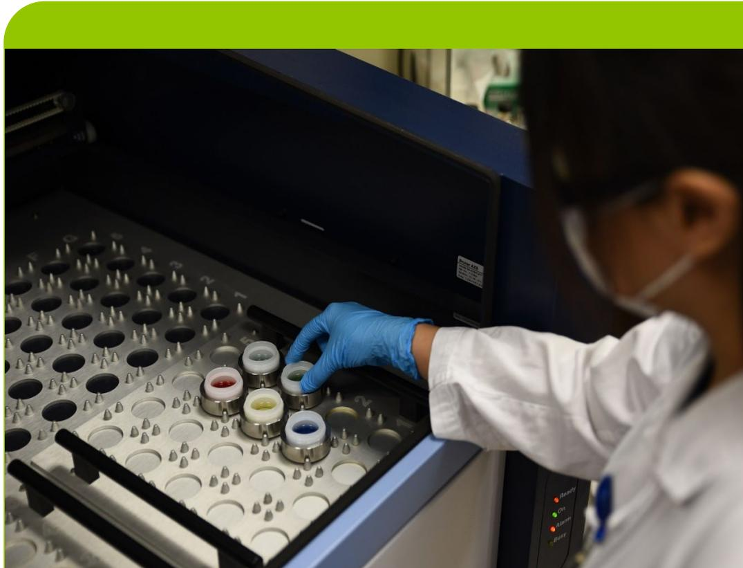
利用波長色散X-射線螢光分光光譜技術分析燃油樣品中硫的含量
