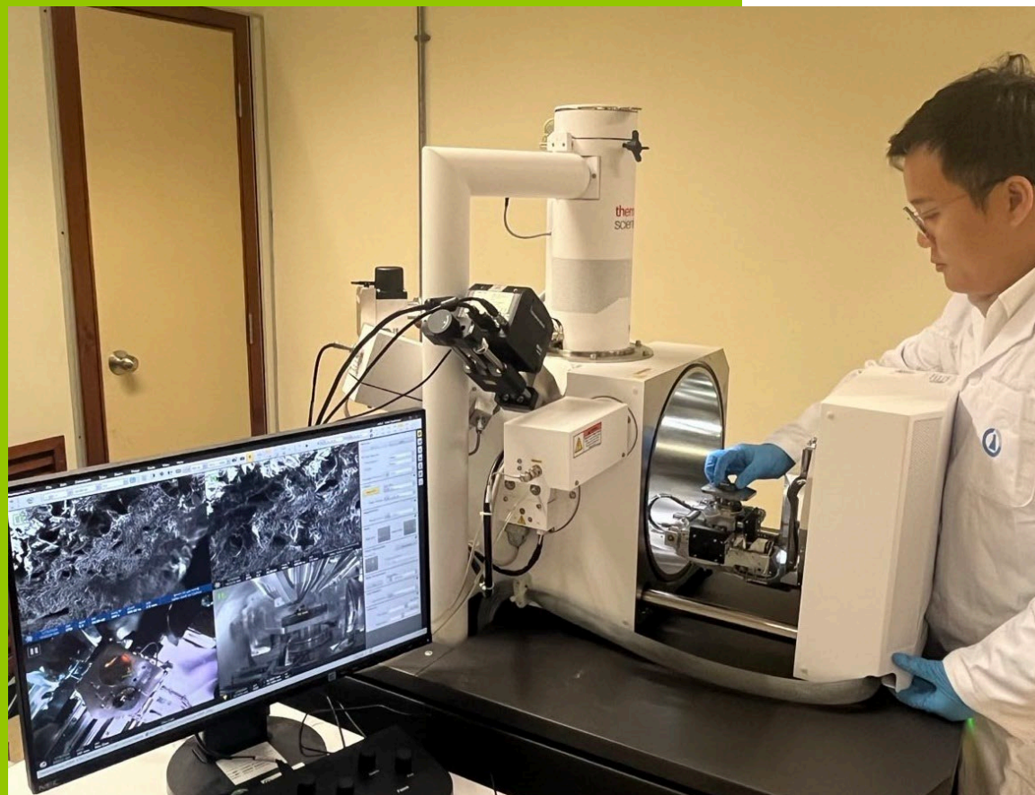
利用扫描电子显微镜对食品投诉样本中的异物进行分析
