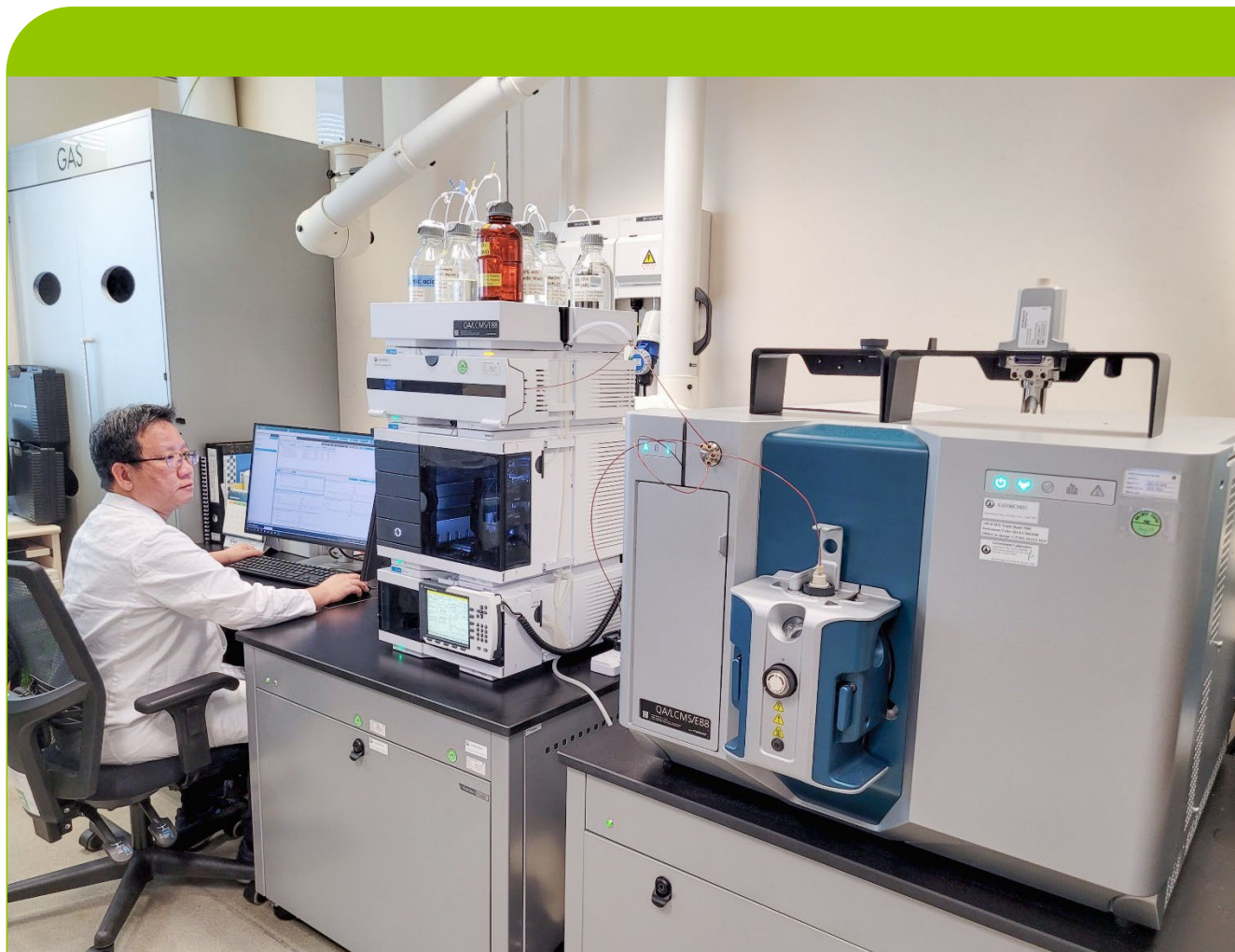
使用液相色谱串联三重四极杆质谱联用法进行样品分析
