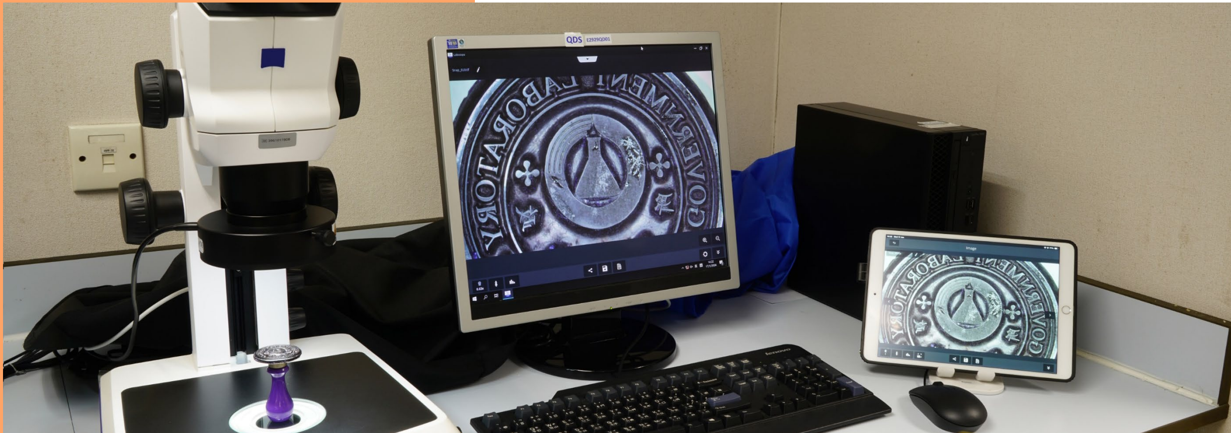
用作检测证物的立体显微镜 (可支援多装置同时观看)
