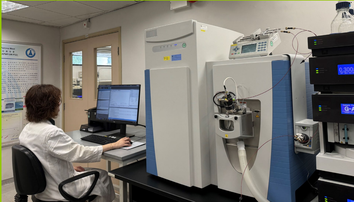
用于食物内除害剂残余分析的超高效液相色谱四极杆静电场轨道阱质谱联用仪
