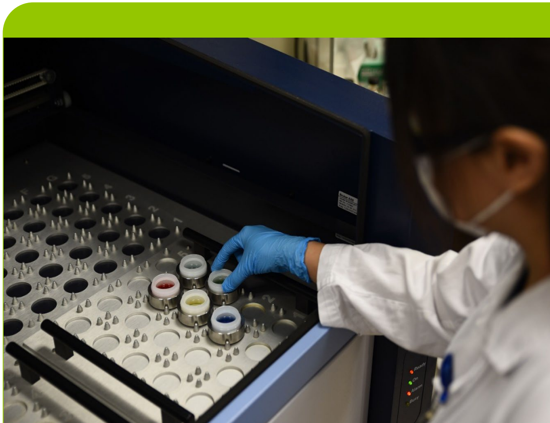
利用波长色散X-射线荧光分光光谱技术分析燃油样品中硫的含量
